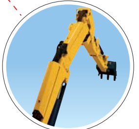
油圧ホースを内蔵したスリッパ配管
