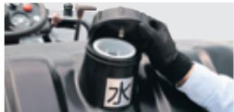
水抜きが容易な散水装置
