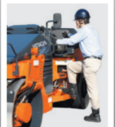
乗り降りが楽な低床・階段式「ヒューマンステップ」を採用。ステップに傾斜がついていますので、楽に乗り降りできます。下段ステップは、滑り止め付きの透過式により、仕上げ面や縁石の確認も容易です。
