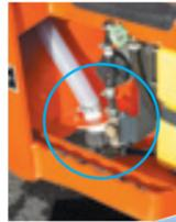
排水口をステップ部に配置。(ZC50C-3/ZC50T-3) 排水作業が容易に行えます。
