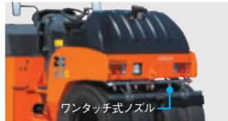
樹脂製の散水タンクにはストレーナと大口径の給排水口を装備。さらに散水装置は、着脱に便利なワンタッチ式のノズルを採用し、清掃作業が容易にできます。
